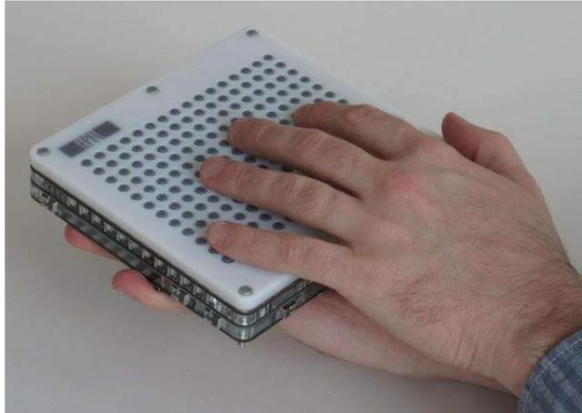
Figure 5 : Exemple de dispositif d'affichage tactile par des picots<sup>6</sup>.
